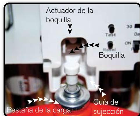
Para insertar la carga asegurar que la salida de la boquilla está situada al lado contrario de la etiqueta. Comprobar el actuador de la boquilla está situado arriba, sino subirlo hacia arriba con el dedo para facilitar la inserción de la carga. La carga debe entrar horizontal y recta. Situar la patilla del cuello de la carga en la guía de sujeción de la carga del dispensador. Para retirar la carga, deslizarla directamente hacia fuera sin girarla.
