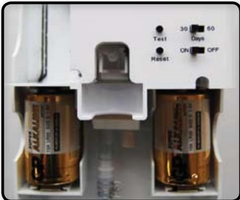
2. En nuevas instalaciones presione el botón "Test" para purgar el sistema con el fluido. Para reprogramar el sistema a un nuevo programa de servicio pulse el botón "Reset" cuando substituya las cargas.
